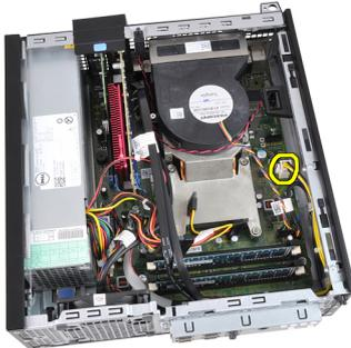
7. Retirez le cordon électrique 4 broches des clips du châssis.
