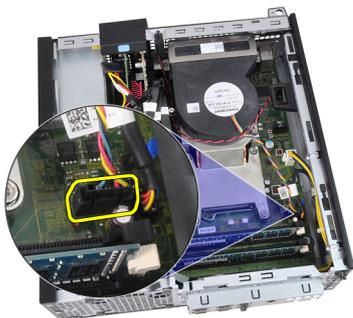
6. Retirez le câble de la carte d'entrée/sortie ou le câble FlyWire du chemin sur le dissipateur de chaleur.
