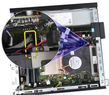
7. Retirez la vis de fixation du panneau E/S au châssis.
