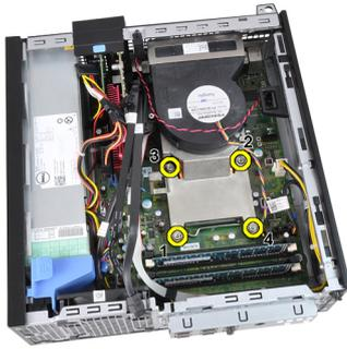
8. Soulevez le bloc dissipateur de chaleur et retirez-le de l'ordinateur. Posez le bloc en tournant le ventilateur vers le bas, la graisse thermique orientée vers le haut.
