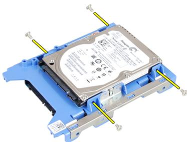
7. Desserrez les vis de fixation du disque dur de 2,5" en dessous du support du disque dur .
