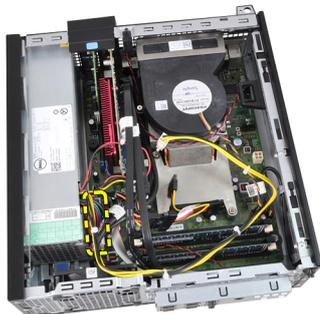
9. Retirez les vis de fixation de l'alimentation électrique à l'arrière de l'ordinateur.
