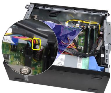
6. Retirez le câble du commutateur électrique du clip du châssis.
