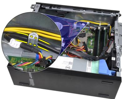
7. Ecartez le câble du commutateur électrique du châssis.
