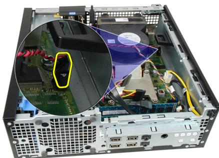
4. Faites glisser le commutateur d'intrusion à l'intérieur et retirez-le de la carte système.
