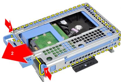
5. Courbez le support du disque dur et retirez le disque dur de 3,5" ou les deux disques durs de 2,5" du support.
