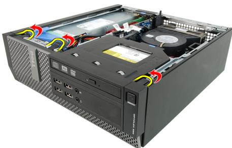
4. Tournez le cache pour l'écarter de l'ordinateur et libérer les crochets sur le bord opposé du cache sur le châssis .
