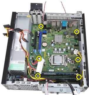
11. Retirez la vis de fixation hexagonale de 7 mm de la carte système au châssis.
